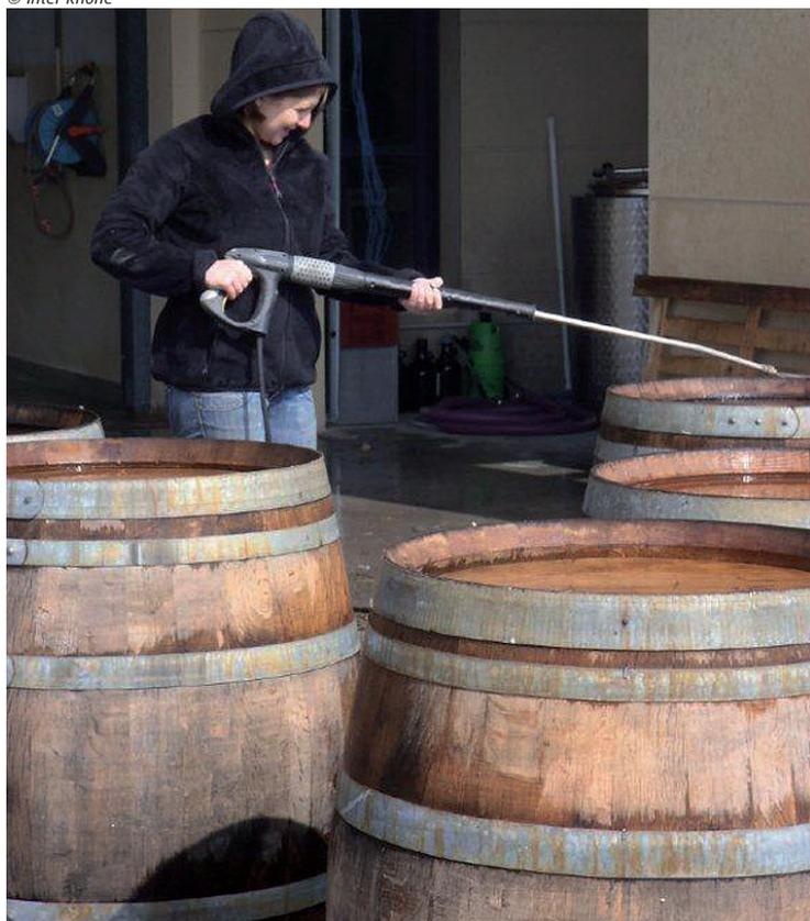
plissage des 3 barriques nettoyées par l'eau ozonée a rapidement été recontaminé (fig. 5bis). Contrairement à celui des barriques traitées par trempage chimique qui s'est peu recontaminé, peut-être à cause d'un rinçage insuffisant qui aurait permis une rémanence toxique des produits employés dans les couches intermédiaires du bois (fig. 4bis). En effet, ces produits chimiques doivent être éliminés par de grandes quantités d'eau pour retrouver un pH neutre et l'odeur initiale du bois.
